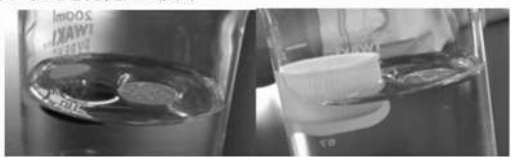
図1 (右)同じ状態(β)の物質同士の接近 (左)異なる状態の物質同士の接近 (PETキャップ、ビーカーの壁: α、一円玉: β)
