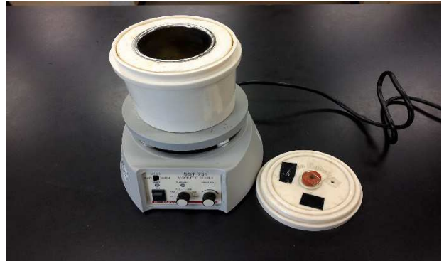
写真1 攪拌機に乗せた水熱量計
